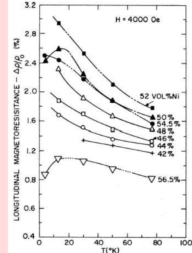
FIG. 10. Longitudinal magnetoresistance vs  $T$  ( $H = 4000$  Oe).
